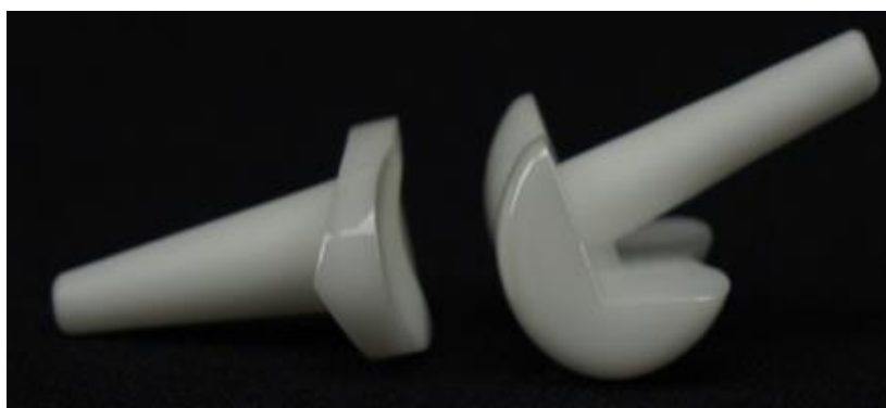
Рисунок 2 – Компоненты нового эндопротеза ПМФС после финальной полировки
